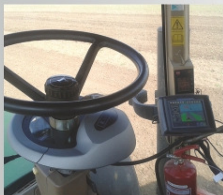
AGROAVAR družstvo agropodnikateľov Biňa - RTK automatické riadenie na JD 8100
