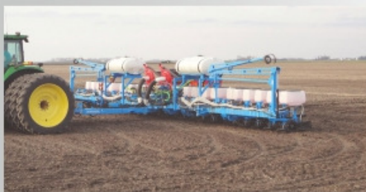
Aplikácia RAVEN OMNIROW na sejačke Monosem NG PLUS 4
