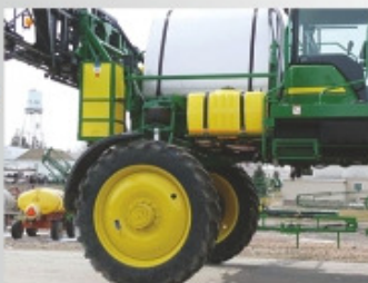
Montáž injektora RAVEN SIDEKICK na JOHN DEERE 4730 s dvoma koncentrátmi pesticídov
