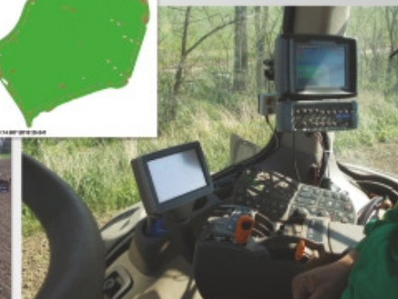
Donau farm Kalná s.r.o. automatické vypínanie postrekových sekcií a riadenie dávky do ha cez GPS
